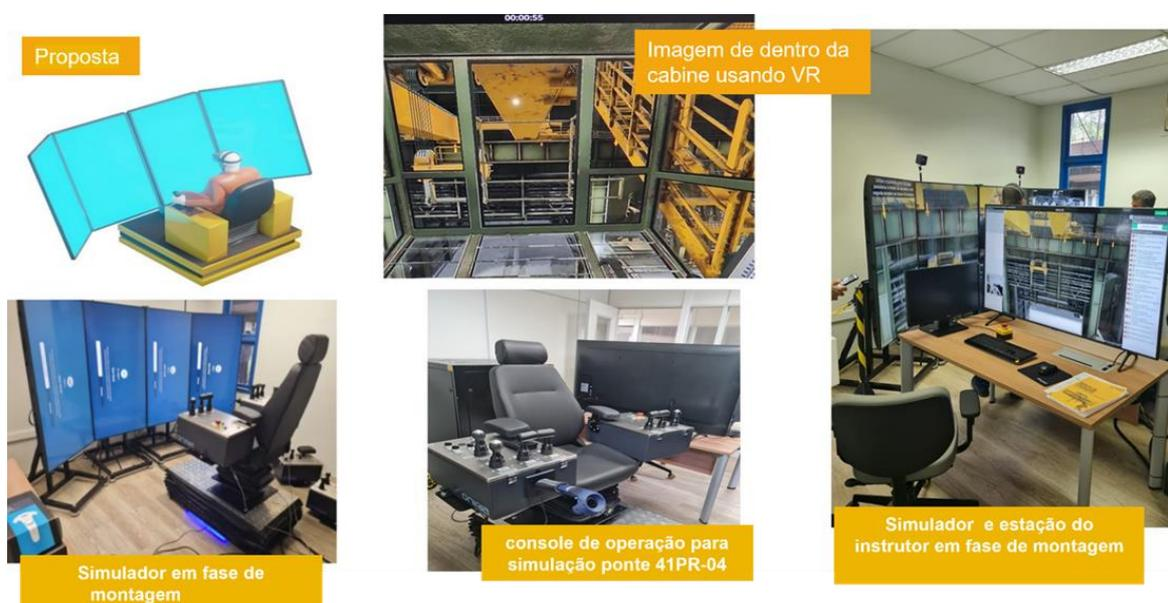
A solução traz uma proposta avançada na escala de simulação. Trata-se de um conjunto composto por assento móvel, consoles e manetes que reproduzem os equipamentos de forma muito próxima ao cenário real, além de um conjunto de telas e dispositivo de realidade virtual de última geração (óculos VR), que proporcionam uma experiência audiovisual imersiva nos cenários modelados em 3D.
